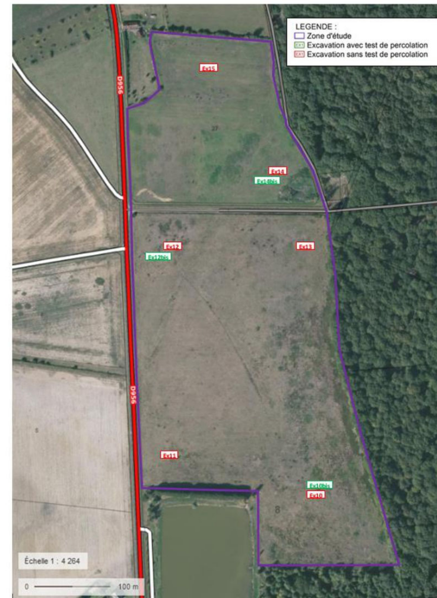
Figure 19 : Localisation des sondages réalisés sur site – Zone Nord (Source : SOND&EAU)
